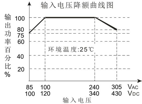
注:①对于输入电压为85~100VAc/240~305VAc/100~120Vdc/340~430Vdc,需在温度降额的基础上进行电压降额;
